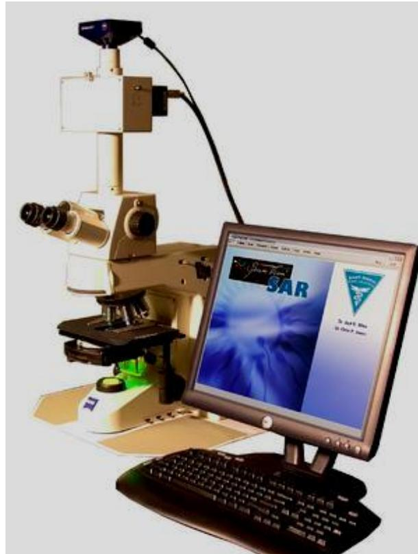
Рисунок 23. Система компьютерного анализа микроскопических объектов
