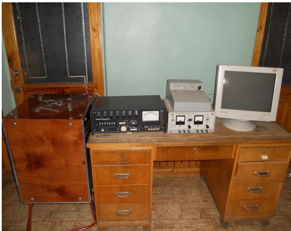
Рисунок 3 – Измерительный стенд микрокалориметра
