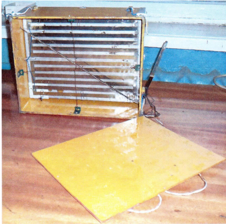
Рисунок 7 – Лабораторная установка для измерения теплового сопротивления
