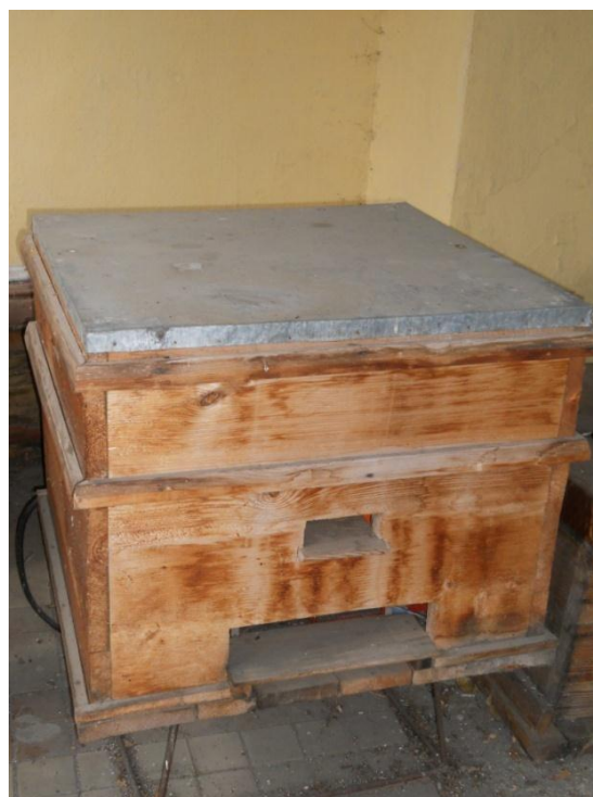
Рисунок 5б – Улей-калориметр в деревянном кожухе
